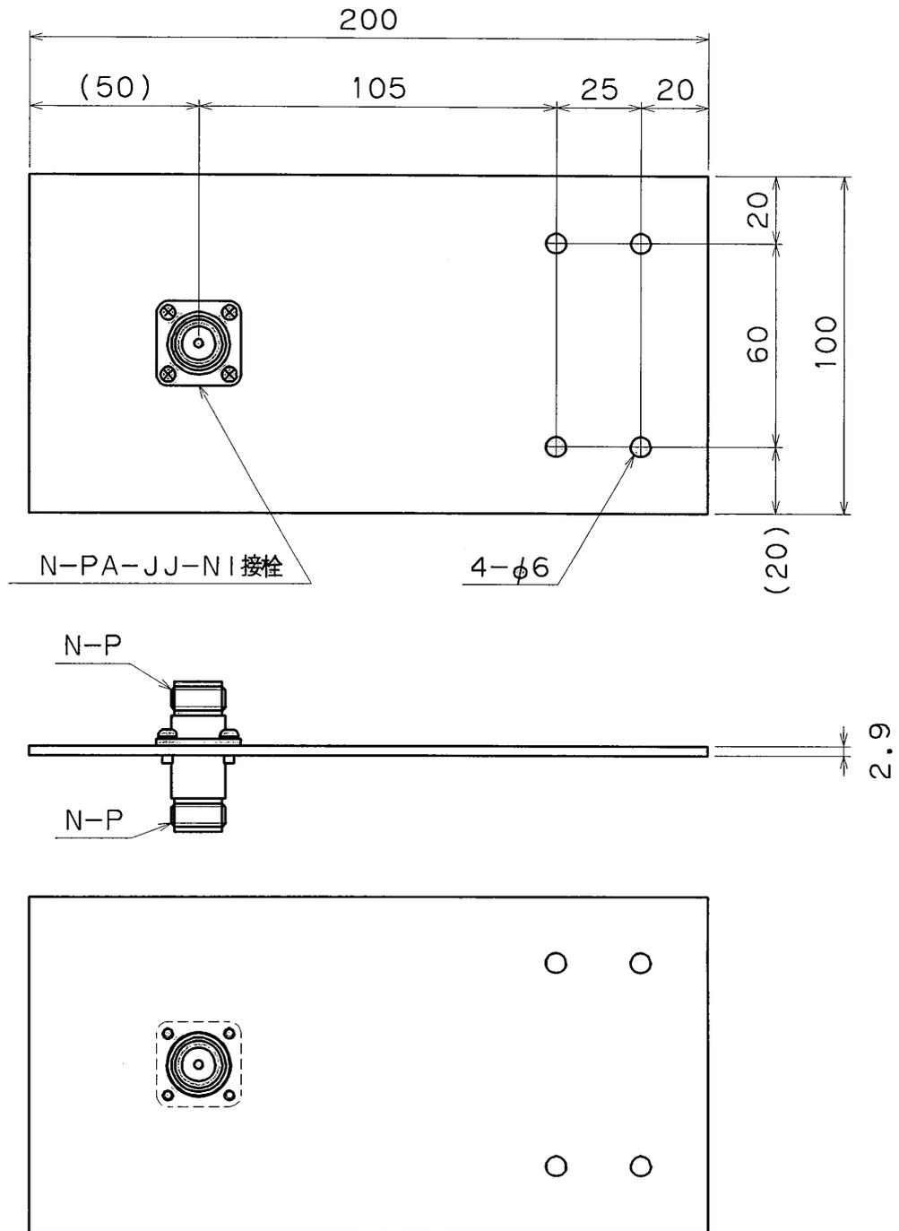
取付板材質：冷間圧延鋼板 板厚2.9mm 亜鉛メッキ処理
