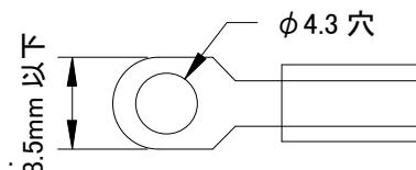
**▲危険** 配線に用いる電線の先端は絶縁スリーブ入りのM4丸端子をご使用ください。
