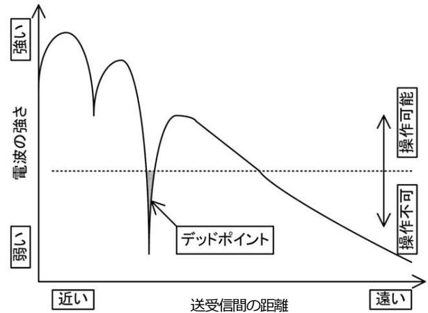
ダイバーシチ受信では、2本のアンテナを自動的に切り替えて受信することで、デッドポイントを回避します。
