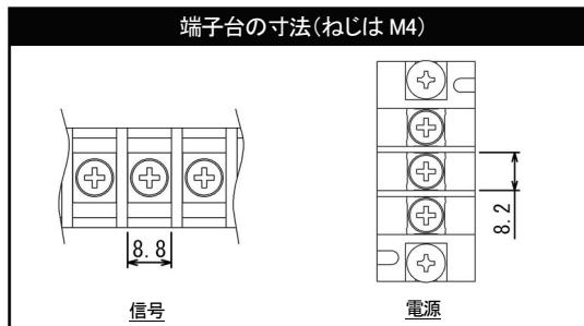
**適合圧着端子の例(日本圧着端子製の場合)**
